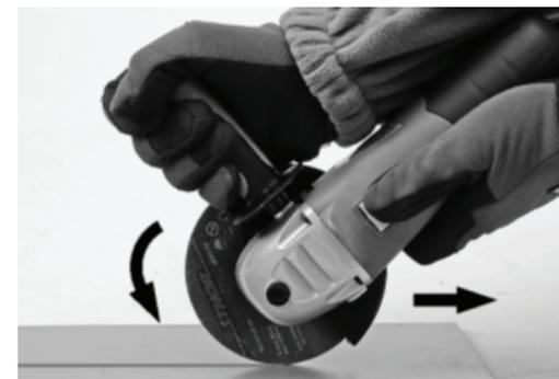
**Внимание!** Не пытайтесь использовать отрезной диск для шлифования боковой поверхностью, это может его разрушить! Возможно получение травмы!
