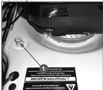
Рис. 29 Расположение коннектора для подключения шланга
