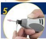
**5** Con el bloqueo activado, apriete la tuerca de la boquilla con la llave hasta que el vástago del accesorio se agarra al portaherramientas. Pero no es necesario apretar excesivamente la tuerca de la boquilla.
