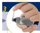
Удерживая кнопку фиксации в нажатом состоянии, ослабьте гайку цанги при помощи гаечного ключа.
